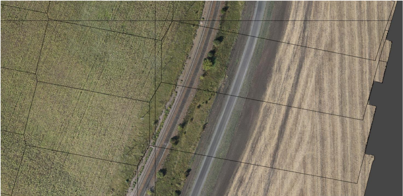
Рис. 4. Ортофотоплан с отображенными линиями реза фотографий. Видно, что в автоматическом режиме были выбраны крупные, с ровными гранями элементы исходных изображений, благодаря этому ОФП сшивается без грубых ошибок. Если эти элементы с грубыми, неправильными краями, разбиты на довольно мелкие части — стоит подобрать более корректные линии реза. Для этого нужно создать фигуру и выбрать в ней наиболее подходящий и сходящийся с соседними элементами снимок
